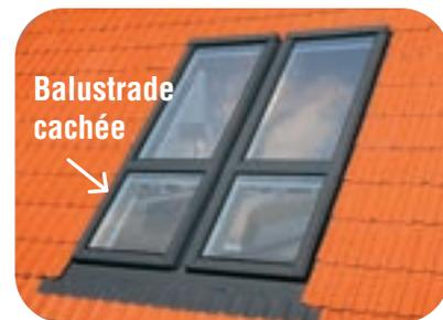
Le vantail supérieur peut être soulevé en douceur jusqu'à un angle de 45°. Les garde-corps latéraux de sécurité sont intégrés dans le vantail inférieur et basculent vers l'avant lors de l'ouverture du vantail.
